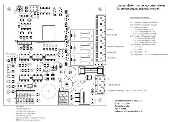
Abb. 1 – Lage der Anschlüsse, Testpunkte und Einstellmöglichkeiten
